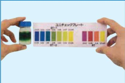
●変圧器・遮断器・開閉器・コンデンサー・ケーブルなどに使用されている電気絶縁油の全酸価が現場で判定可能
