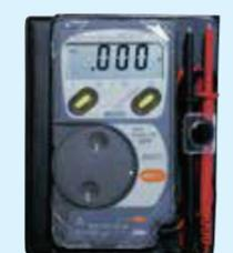
● 電圧測定専用、短絡防止の安全なテスター棒採用
