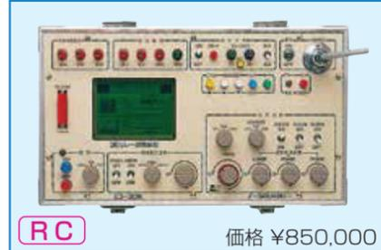
●単相電源で3Eリレーの試験・データをメモリー専用プリンタでプリントアウト可能
