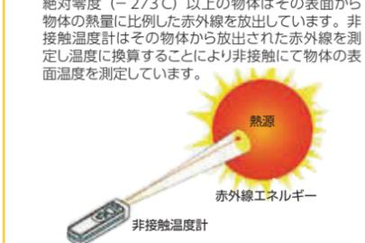
●非接触温度計での正確な温度測定
