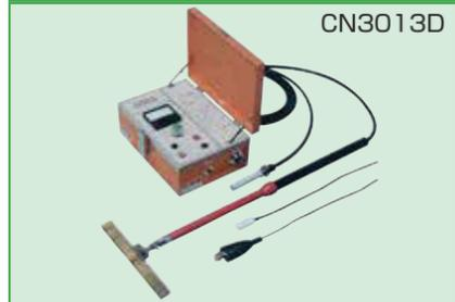
●コンクリート構造物上に施工された絶縁性皮膜のピンホール検査が電気的に非破壊で可能
