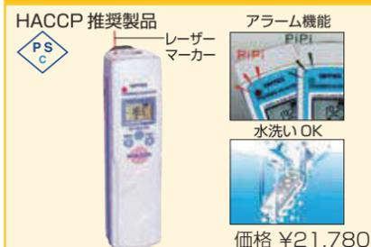
●保護構造IP67 (JIS保護等級7)をクリア、水洗いにも壊れない防水・防塵ボディを実現
