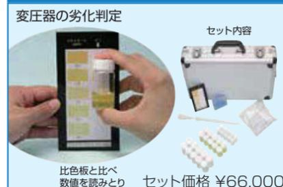
●フルフルール簡易測定試薬による絶縁油のフルフルール濃度の測定で変圧器の劣化を簡単に判別
