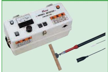
●低周波パルス放電と低電流出力で塗装膜、ライニング膜をいためることなくピンホールを探知
