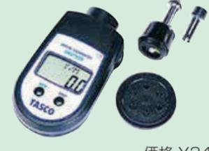
● ポケットにもすっぽり入るコンパクトサイズで軸の回転数、速度、長さ計測可能
