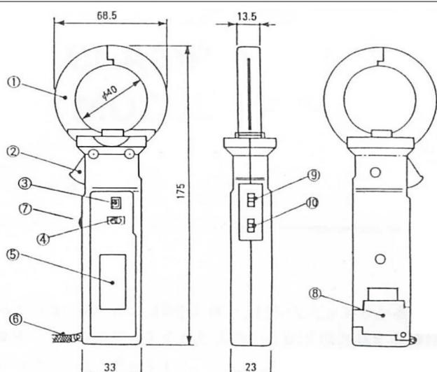
①クランプ式CT 電流検出用センサで、クランプ式になっています。
