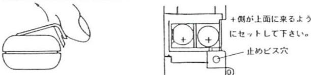
注記 新しい電池と交換する場合は2個とも同時に交換して下さい。
