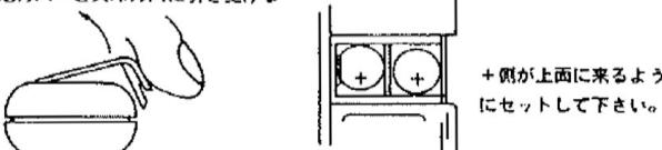
注記 新しい電池と交換する場合は2個とも同時に交換して下さい。
