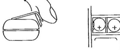
注記 新しい電池と交換する場合は2個とも同時に交換して下さい。
