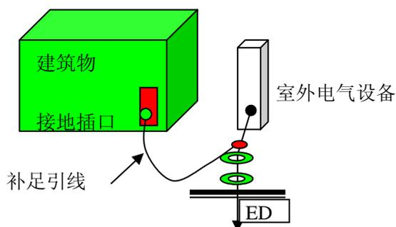
空调等室外电气设备接地电阻的测试:
