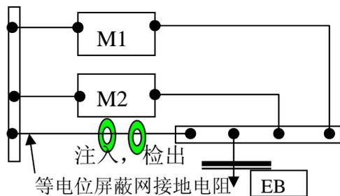
等电位屏蔽网接地线接触不良时，显示值偏高。
