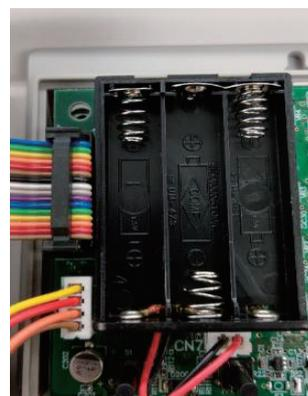
右図の電池ケースに、方向に注意して単 4 電池を 3 本入れてください。電池交換後にケースを組み立ててください。
