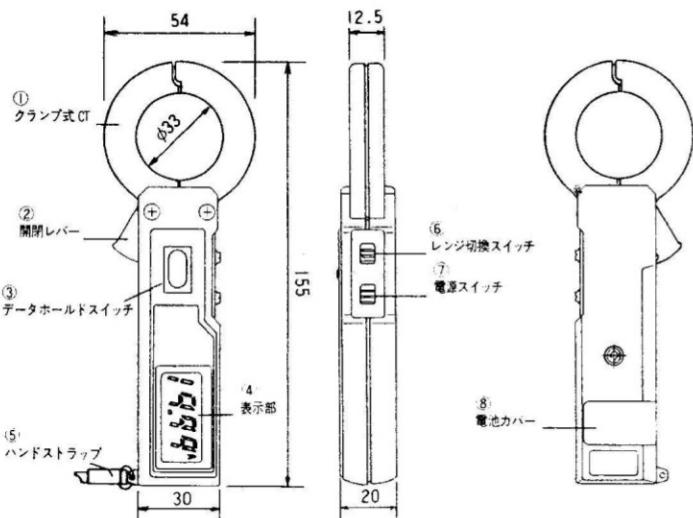
① クランプ式 CT 電流検出用のセンサで、クランプ式になっています。
