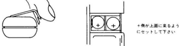
注記 新しい電池と交換する場合は2個とも同時に交換して下さい
