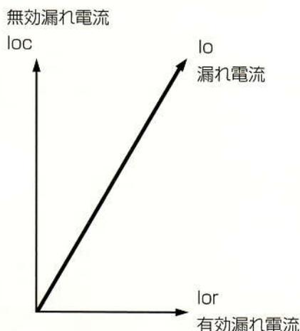
絶縁抵抗計による絶縁性能の判定が困難な場合には、漏れ電流が1mA以下であることを確認することで対象電路が十分な絶縁性能を有することが確認できます。しかし電路に接続されている機器のラインフィルタ等による対地静電容量やインバータ機器等による無効漏れ電流 [loc] が、対地絶縁抵抗に起因する有効漏れ電流 [lor] に対して大きな場合には、絶縁抵抗計による絶縁性能が「良」の場合でも、漏れ電流 [Io] の判定では「不良」と判定されるケースがあります。有効漏れ電流 [lor] に基づく絶縁不良の判定方法は、従来の漏れ電流 [Io] による判定方法より効率良く絶縁不良の電路が検出できます。
