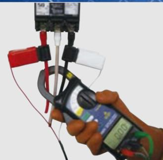
情報機器等の普及により電気設備の保守/保安においては「無停電」での絶縁管理が求められています。クランプリーカによる絶縁管理は、絶縁抵抗計による「停電し電圧を印加する測定」ではなく「漏れ電流測定」による活線絶縁管理です。設備を長時間停電させることなく活線状態での管理が可能となります。
