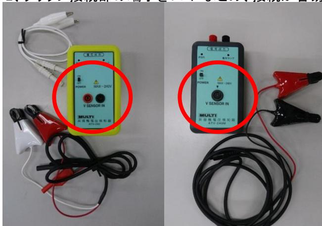
3、試験器の入力コードを直接クリップできるように出力部を端子台に変更、クリップコードを廃止。
